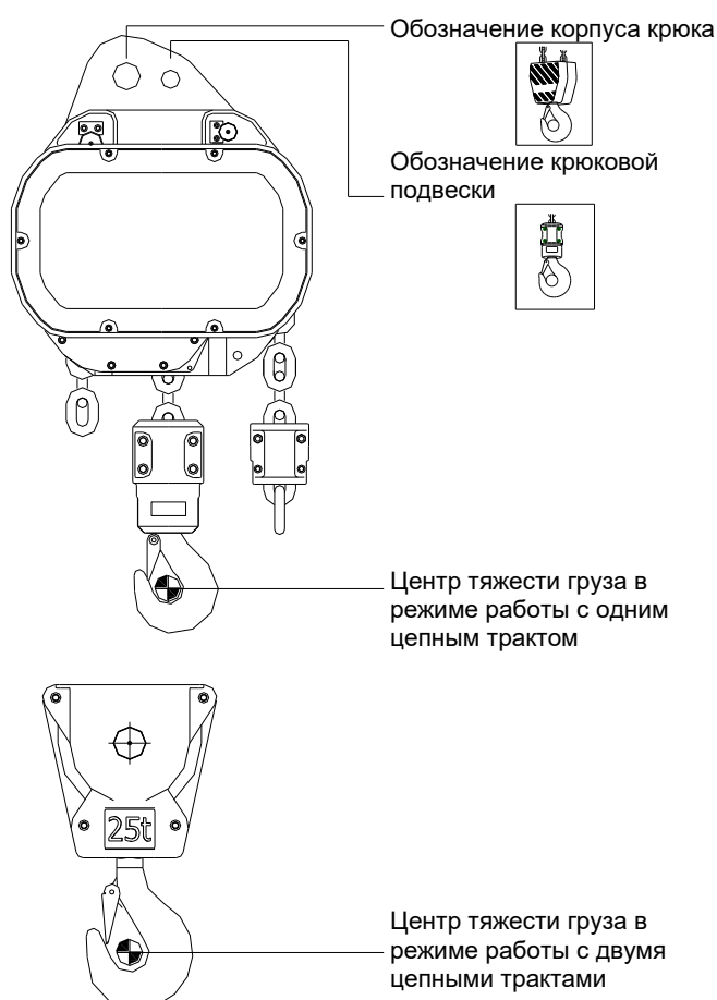
Рис. 8.: Центр тяжести груза в режиме работы с одним и двумя цепными трактами
